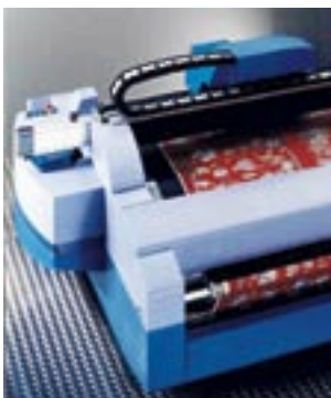
▲ Der ChromoJet-TS wurde speziell für Frottee und andere schwere Textilien entwickelt. bu Englisch zziit niamconse modionum
